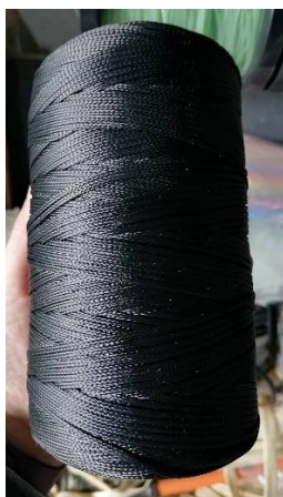
Photo 11 : Fils spécial 1.5 utilisé pour renforcer la poche de la STC
