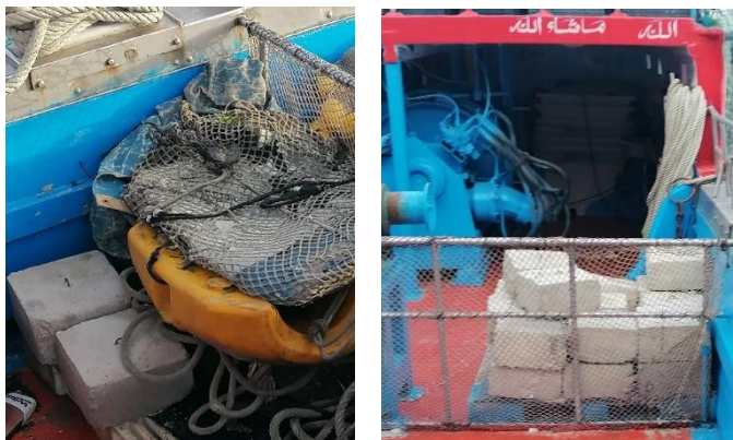
Photo 10 : Béton armé utilisé pour alourdir les grandes STC
